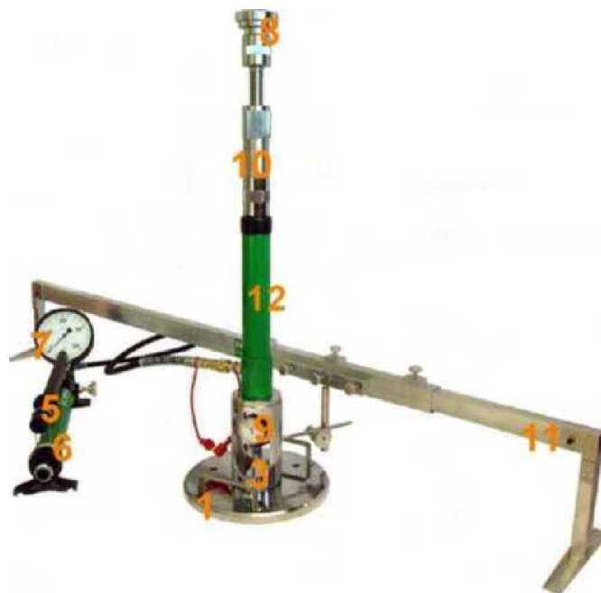
Rys. 1.2. Aparatura VSS z jednopunktowym pomiarem przemieszczenia płyty
